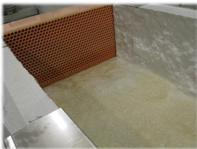
Figur 5 visar lugnaren längst uppströms kanalen.
