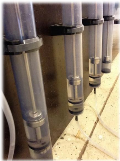
Figur 9 visar närbild på flytkorkarna som flyter på ytan i rören och mäter nivån från botten.
