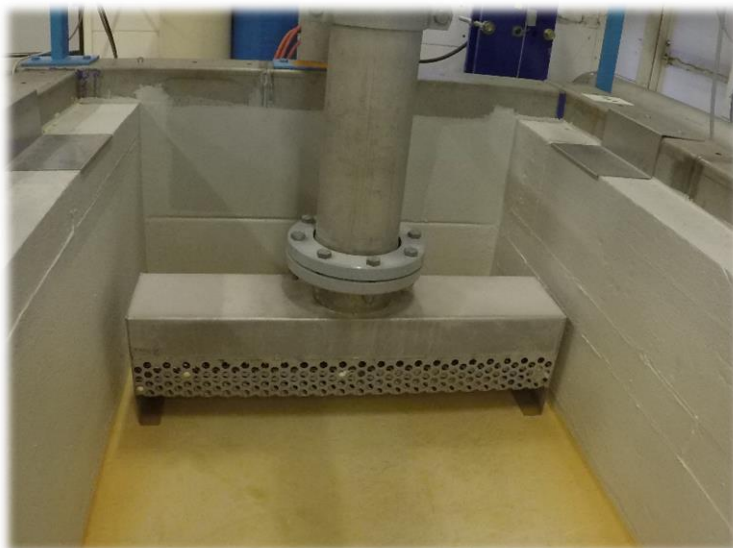
Figur 7 visar munstycket var vattnet kommer från till rännan.
