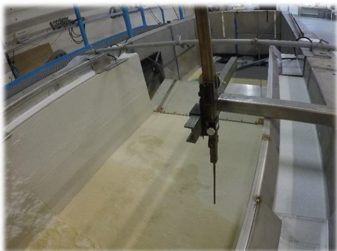
Figur 10 visar spetsmätaren längst ner efter sektion 14.
