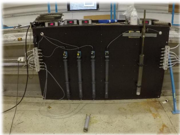
Figur 8 visar en överblicksbild av tryckmätarna, displayerna och även slangarna från sektionerna.
