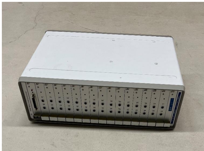
Figur 6: Datainsamlingsenhet CTA 88 som används vid temperatur-, och lufthastighetsmätning med anemometrar.
