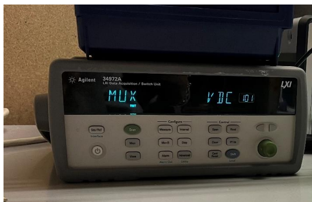
Figur 7: Datainsamlingsenhet för temperaturmätning med termoelement på 16 punkter i rummet.
