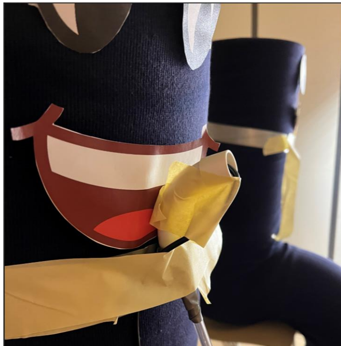
Figur 11: Metod för tillförel av koldioxid ur den större genomskinliga slangen som är kopplad till ett vitt svängande rör. Mätning av koldioxidkoncentrationen vid källan görs ur den mindre svarta slangen som är placerad inuti det svängande röret.
