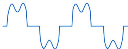
Fig. 3. Spänning och ström avvikandes från sinusformen innehållandes övertoner.
