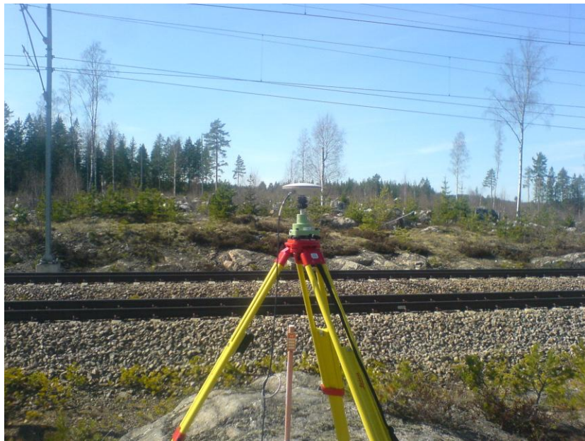
Figur 3. Uppställning över känd punkt med tvångscentrering.
