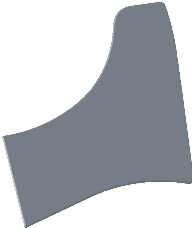
Figur 11 Styrvingen till vindkraftverket sedd från sidan.
