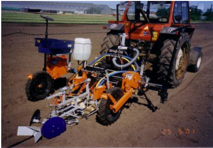
Bild 1. Såmaskin som lägger ut så-folie. Vissa delar är standard, medan andra är specialtillverkade. Foto: Carsten Holmgaard Nielsen
