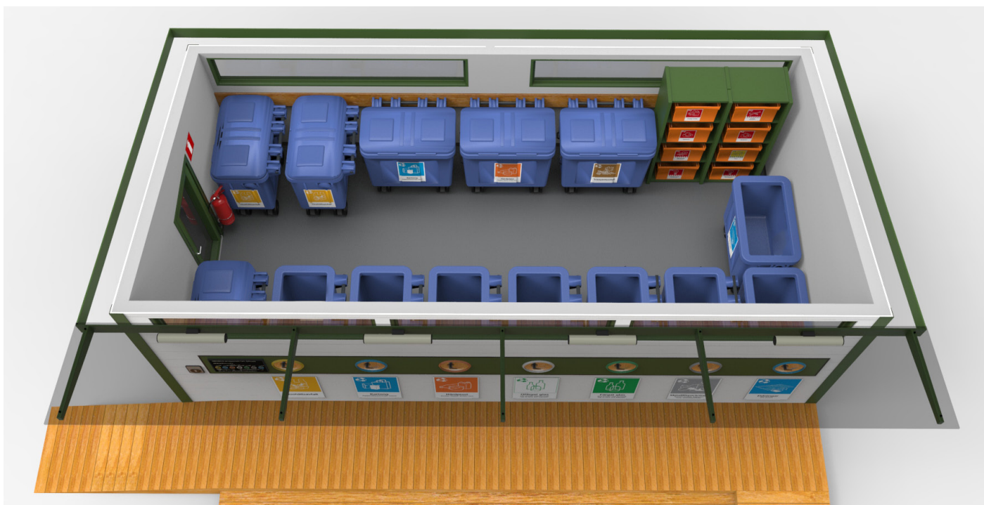
Trälisten i midjehöjd bakom kärnen skyddar väggen från stötar och slitskador.
