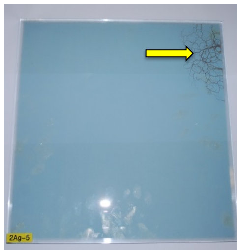
Fig 5. Sprickor i beläggningen på 2Ag-glasets som resultat av HPM-exponering.
