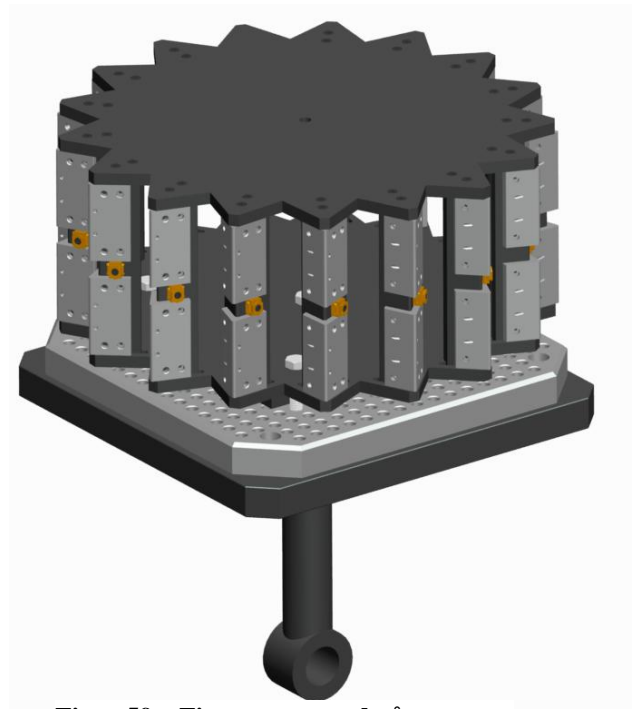
Figur 59 – Fixtur monterad på maskinbord med infästa detaljer
