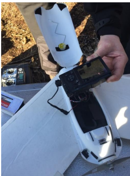
Figur 28. UAS, SmartOne C, med en 16 megapixel kamera, Pentax Ricoh GR placerad i flygplanets undre del.
