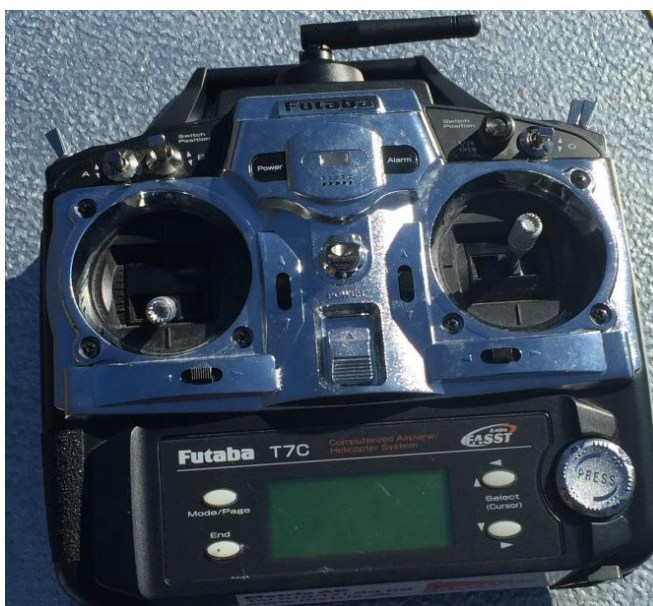
Figur 29. Styrkontroll för manuell manövrering av flygplanet. Styrkontrollen användes vid starten, vid övergången till automatisk flygning och vid nedtagning av flygplanet till marken.
