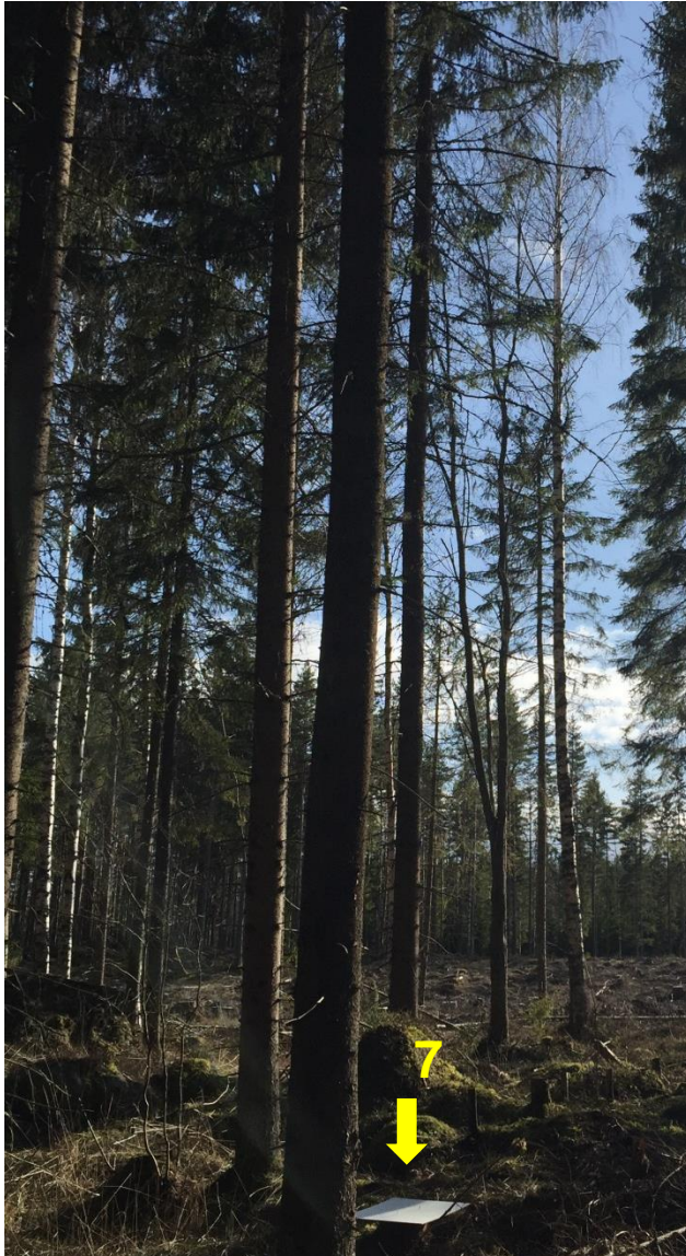
Figur 10. Den signalerade fiktiva gränspunkten 7, placerad i ett område med hög skog och därför svårighet att få fixlösning. Foto taget mot söder.
