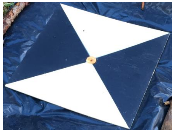
Figur 26. Timglasmönstrad flygsignal 21, 0,40x0,40 m.
